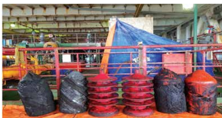
Hình 11. Các loại thoi đã sử dụng để làm sạch đường ống ngầm MSP-8 → MSP-9 ở Bạch Hổ.
